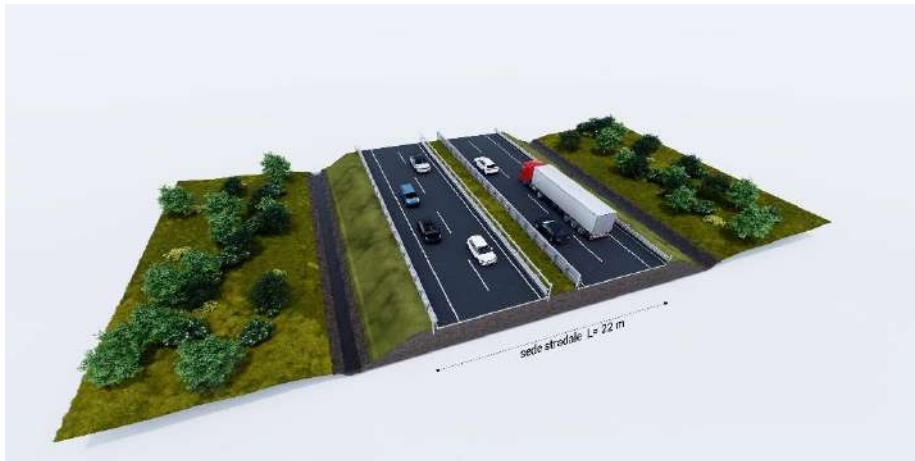
Figura 3-1 – Sezione tipo strada di categoria “B”
