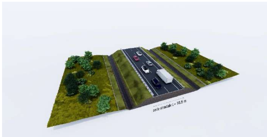
Figura 3-2 – Sezione tipo strada di categoria “C”
